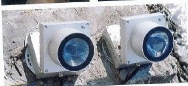
看似相同的两个灯具，具有不同的反射器和出光形式，特别是重点照明需要定向的投光性投光灯。品牌：锐，光束角：6°，额定功率：35W，光束角：10° x 50° 额定功率：35W
